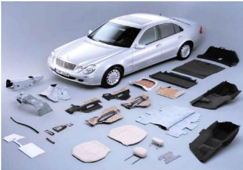
Abbildung 2: Naturfaser-Verbundwerkstoffe werden bei Mercedes Benz- E-Class zur Herstellung von 50 Bauteilen verwendet (Elfaleh et al. 2023, S.23)
