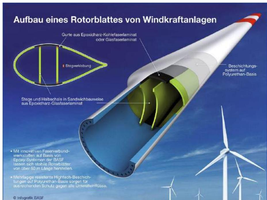
Abbildung 2: Aufbau eines Rotorblattes von Windkraftanlagen (Vogel Communications Group)
